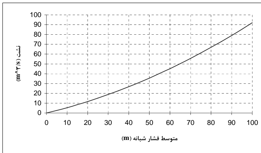
نمودار ۳- رابطه شاخص نشت با فشار ( Leakage = 0.5 \times AZNP + 0.0042 \times (AZNP)^2 )
