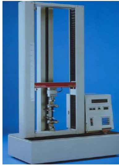
شکل ۷ - نمونه دستگاه آزمایش کشش
