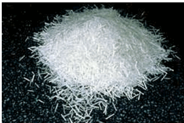
شکل ۲ - الیاف شیشه نوع E به شکل Chopped strand mat
