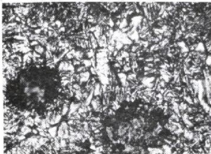
شکل ۴ - ریز ساختار آلیاژ ۲ درصد آلومینیوم، دمای آستمپر کردن ۳۳۵ درجه سانتیگراد و زمان آستمپر کردن ۱۵ دقیقه (×۴۰۰)
