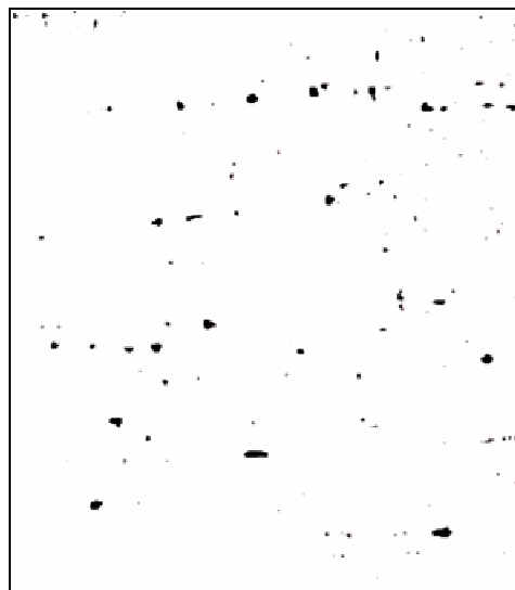
شکل ۵. نمونه عملیات حرارتی شده ای فولاد CK 45 که مرحله دوم عملیات حرارتی آن به مدت ۸ ساعت در دمای ۷۵۰ درجه سانتیگراد انجام شده است. بدون اچ و بزرگنمایی ۵۰ برابری باشد.
