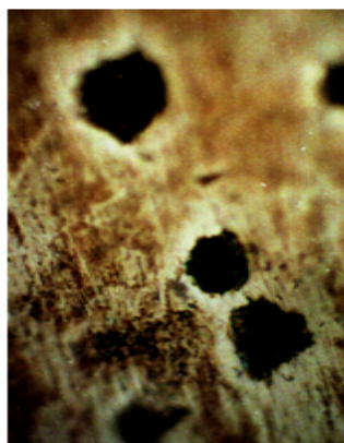
شکل ۹. نمونه عملیات حرارتی شده در ۷۵۰ درجه سانتیگراد. بزرگنمایی ۱۰۰۰ برابر، ۴۰ ثانیه در محلول نایتال ۲٪ اچ شده است. گرافیت‌ها از نوع تمپر شده می‌باشند.
