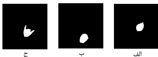
شکل ۴. تصاویر دودویی بدست آمده با استفاده از روش آستانه‌گیری otsu. الف. حرف a، ب. حرف o، ج. حرف b
