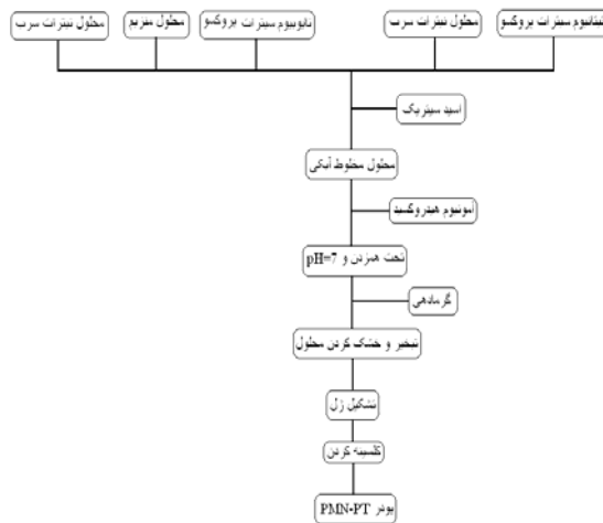
شکل ۱: گردش کار تهیه پودر PMN-PT
