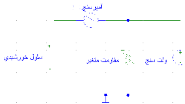
شکل 9 تصویری از چیدمان اندازه گیری مولفه ولتاژ و جریان سلول خورشیدی.
