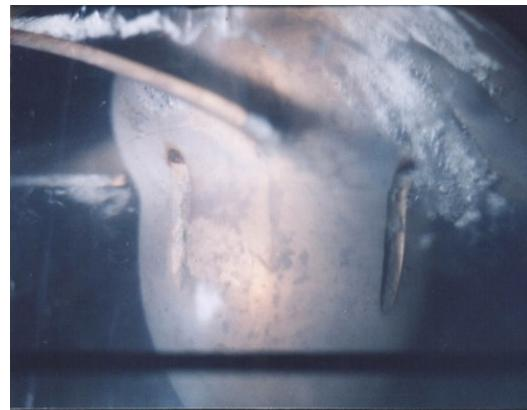
شکل (۷) : کاویتاسیون روی سطح پره و ریشه و همچنین کاویتاسیون گردابه‌ای در لبه پره (Vortex Cavitation)
