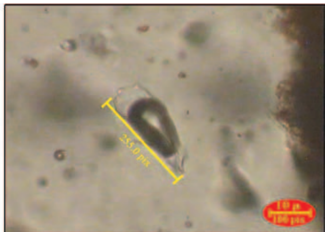
شکل ۱۲- تصاویری از سیالات گروه C که از دو فاز گاز و مایع (با حجم بیشتر گاز) تشکیل شده‌اند. تصاویر از نمونه Tf3a
