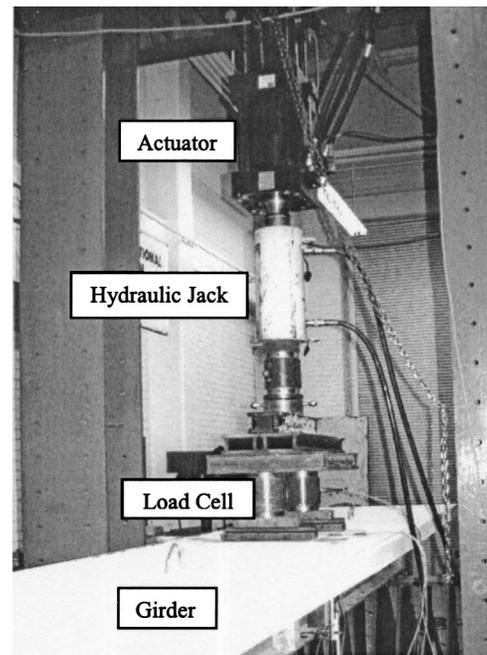
**Fig. 6.** Test setup
