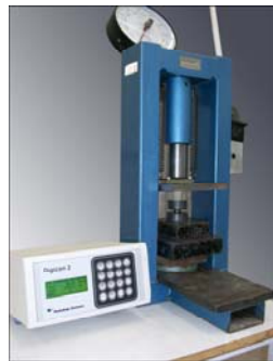
شکل ۱۶- مجموعه بارگذاری فشاری با جک دستی و داده نگار
