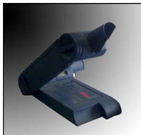
شکل ۳- دستگاه تعیین نقطه ذوب الکتروترمال
