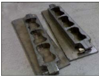
شکل ۶- قالب‌های سه‌قلوی نمونه‌های کششی
