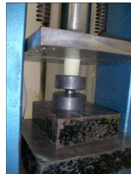
شکل ۱۵- نمونه‌ی فشاری بر روی تکیه‌گاه گوی و کاسه
