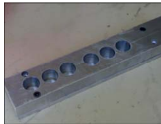
شکل ۵- قالب شش‌قلوی نمونه‌های فشاری
