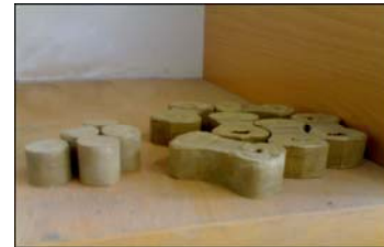
شکل ۱۰- نمونه‌های سمباده زده شده شکل ۱۱- ذوب نمودن سطح بارگذاری با صفحه داغ شکل ۱۲- نمونه‌ها و قالب‌های کششی
