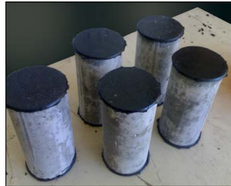
شکل ۱- نمونه‌های بتنی کلاهدک‌گذاری شده
