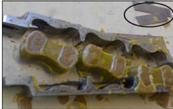
شکل ۱۰- نمونه‌های سمباده زده شده شکل ۱۱- ذوب نمودن سطح بارگذاری با صفحه داغ شکل ۱۲- نمونه‌ها و قالب‌های کششی
