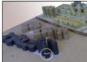
شکل ۸- نمونه‌های کششی و فشاری
