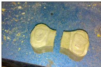
شکل ۱۴- نمونه‌ی کششی پس از شکسته شدن
