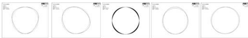
شکل ۳. اشکال مودی حلقه تحت نیروی محوری
