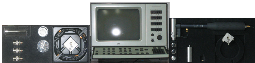
شکل ۲- شتاب سنج، تحلیل گر و چکش ضربه
