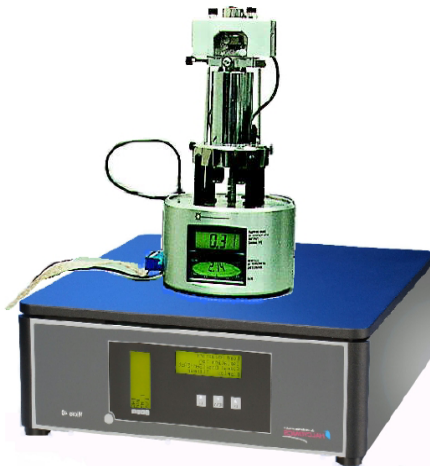
شکل ۱. میکروسکوپ اتمی بر روی یک سیستم ایزولاسیون فعال [18]
