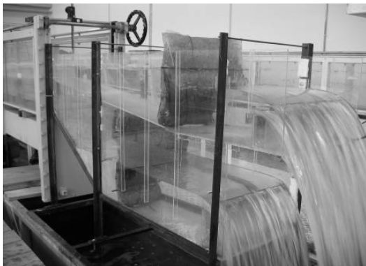
تصویر ۲- نمایی از قسمت اندازه‌گیری دبی به کمک دو سرریز لبه تیز مستطیلی در انتهای کانال دو طبقه
