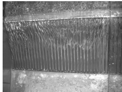
تصویر ۱- کف مشبک با L=20\text{ cm} (الف) کف مشبک با میله‌های طولی، (ب) کف مشبک با میله‌های عرضی
