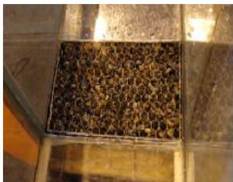
شکل ۳ - نمای کلی از محیط متخلخل آبگیر
