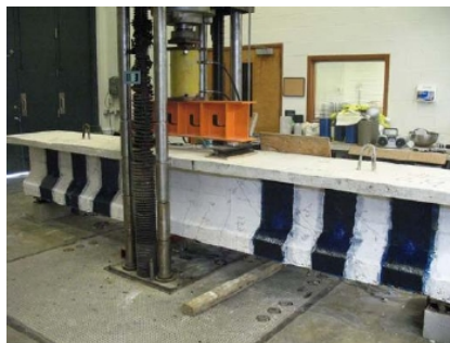
شکل ۵- نمونه‌هایی از بهسازی عضوهای سازه‌ای برای خمش، برش و شکل‌پذیری با FRP
