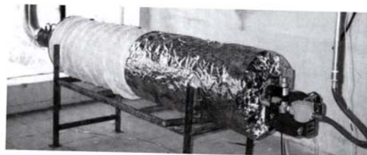
شکل ۲- کوره آزمایشگاهی در هنگام استفاده از سوخت متان
