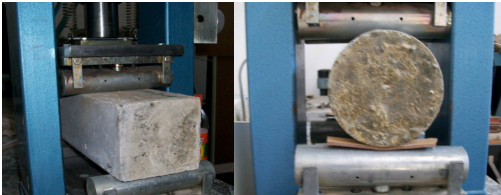
شکل ۲- شرایط تکیه‌گاه و محل اعمال بار در آزمایش خمشی تیرهای مکعب مستطیلی و استوانه‌ای
