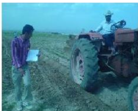
شکل ۱: نحوه اندازه گیری مقدار لغزش در شرایط مزرعه ای. در این شکل نمونه ای از آزمایش بدون بار نشان داده شده است.
