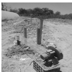
شکل ۱- آماده سازی نهایی زمین آزمایش همراه با دمنده هوا به انضمام چهار دهانه ورودی و چهار دهانه خروجی.
