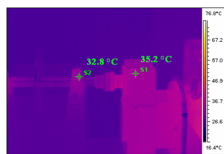
شکل ۷: نمودار ترموگرافی نقطه ۳ در دور ۱۲۷۵rpm
