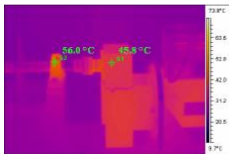
شکل ۱۲: نمودار ترموگرافی نقطه ۳ در دور ۳۰۹۳rpm
