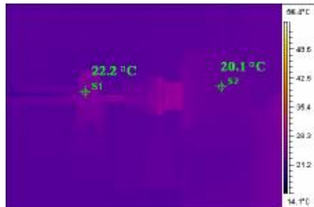
شکل ۱۰: نمودار ترموگرافی نقطه ۱ در دور ۳۰۹۳rpm
