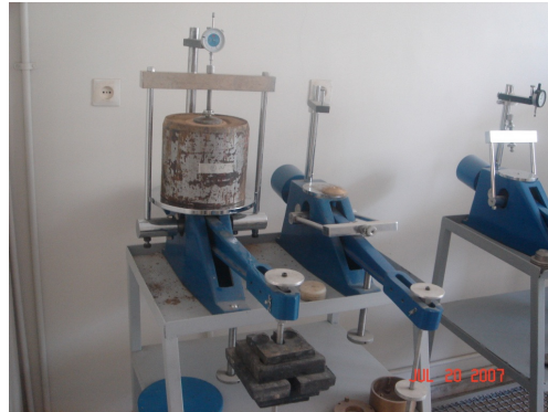
شکل ۲ - دستگاه تحکیم با تغییراتی در ابعاد آن جهت آزمایش بارگذاری صفحه در آزمایشگاه
