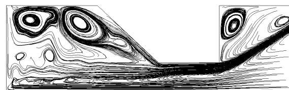
شکل ۹- خطوط مسیر در اتمایزر چرخشی
