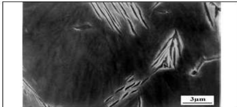
شکل ۶. تصویر SEM از چدن نشکن حاوی ۲/۱۱ درصد Al، آستنیت شده در دمای ۹۲۰°C به مدت ۶۰ دقیقه، آستمپر شده در دمای ۳۵۰°C به مدت ۱ دقیقه.
