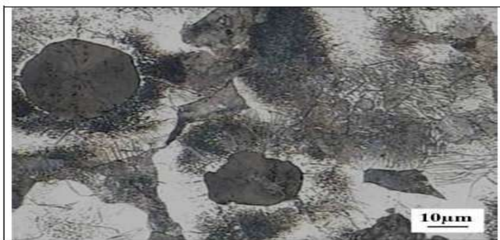
شکل ۳. تصویر میکروسکوپ نوری از چدن فشکن حاوی ۲/۱۱ درصد Al پس از ریخته گری، اچ شده در نایتال ۲٪.
