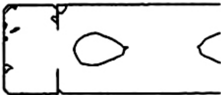
شکل 4: کانتور سرعت محوری صفر در مدل k-ε Standard
