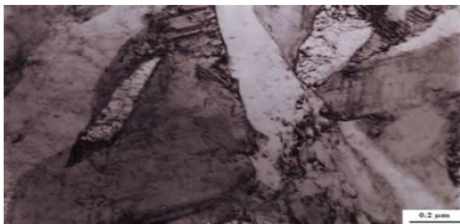
شکل ۴: تصویر میدان روشن (BF) تهیه شده توسط میکروسکوپ الکترونی عبوری از نمونه حاوی ۰/۶۱Al٪ در حالت ریختگی.
