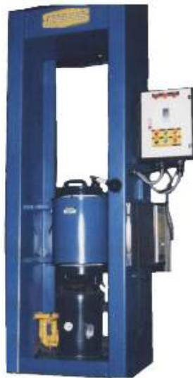
شکل ۵. بخش‌های مختلف سیستم اندازه‌گیری سرعت سردکنندگی روغن‌های عملیات حرارتی
