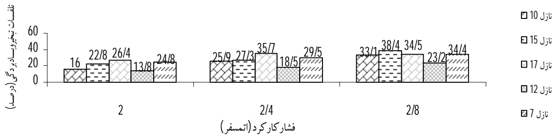
شکل 12- اثر متقابل فشار کارکرد و نوع نازل بر مقدار تلفات تبخیر و بادبردگی
