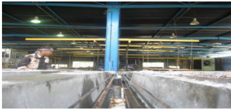
شکل شماره ۱۵- آماده سازی قالب و قرار دادن میلگرد
