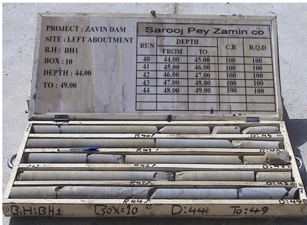
تصویر ۴- نمایی از مغزه‌های بازیافتی در حفاری‌های اکتشافی ساختمانی سد زاوین
