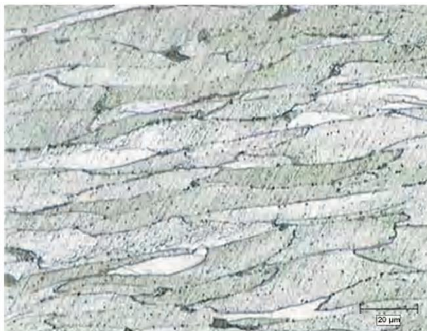
شکل ۱: ریزساختار نمونه‌ی فولادی ۷۵ درصد نورد سرد شده.
