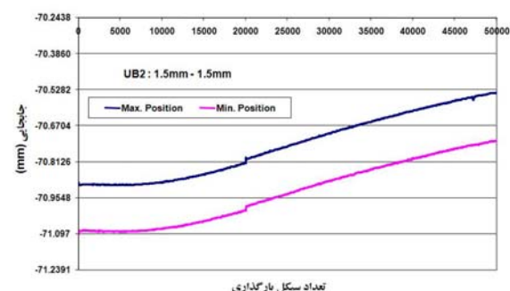
شکل ۲۳ نمودار جابه‌جایی - تعداد دوره بارگذاری برای نمونه UB۱۵-۱۵-۲، P_{max}=650N (شروع انتشار ترک تقریباً در ۸۰۰۰ سیکل)
