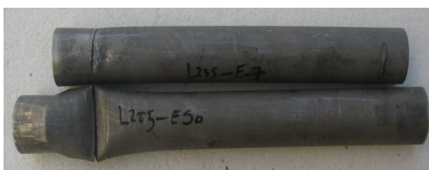
شکل ۴- شکست تعدادی پوسته استوانه ای بعد از انجام آزمایش بارگذاری خمشی تناوبی
