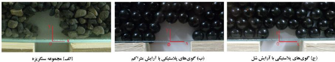
شکل ۳- نمونه قوس زدگی در مصالح دانه‌ای و تشکیل قوس پایدار بر روی دریاچه
