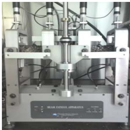
شکل ۴. قاب بارگذاری آزمایش خستگی خمشی تیرچه آسفالتی
