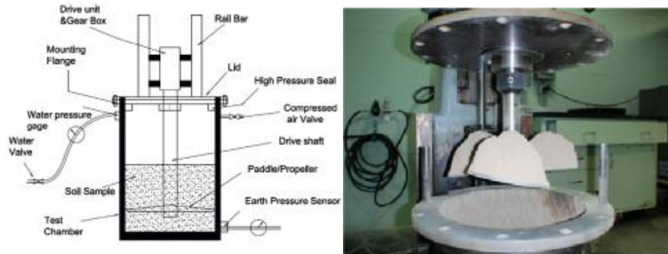
شکل ۱: شما و نمای دستگاه جدید دانشگاه ایالتی پنسیلوانیا و اجزای آن (Rostami et al., 2012)
