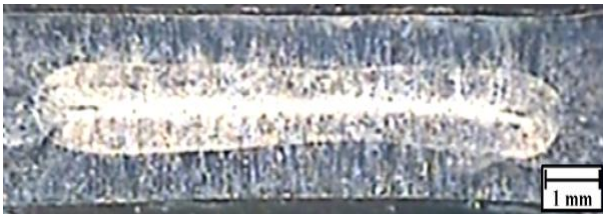
شکل ۲: میکروساختار سطح مقطع عرضی یک نمونه جوشکاری شده
