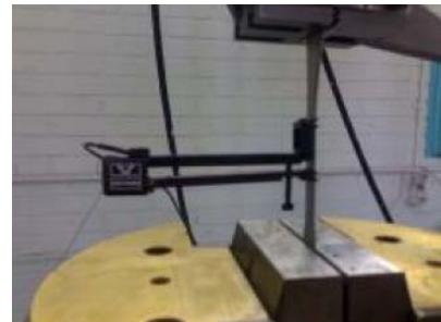
شکل ۱: نمونه تست کشش استاندارد در دستگاه اینسترون ۸۸۰۲
