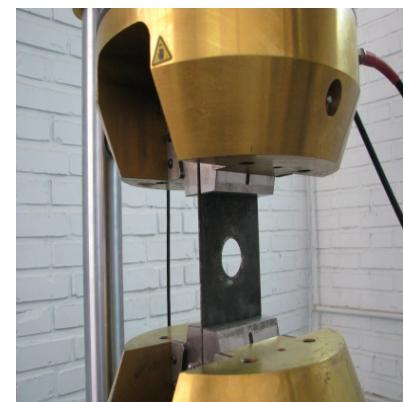
شکل ۳: نمونه بسته شده به فک مخروطی هیدرولیکی در دستگاه اینسترون ۸۸۰۲
