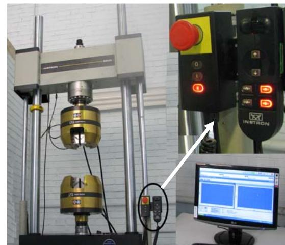
شکل ۲: شمای کلی دستگاه سرو-هیدرولیک اینسترون ۸۸۰۲
