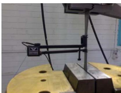
شکل ۴- طریقه‌ی نصب نمونه‌ی استاندارد کشش بر روی دستگاه
