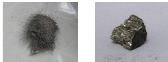
شکل ۲: (الف) تصویر آلیاژ \text{LaNi}_5 قبل از هیدروژن دهی (ب) تصویر آلیاژ بعد از انجام ۳۰ چرخه جذب/وا جذب
