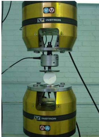
شکل (۴): بارگذاری فشاری نمونه‌های دیسکی با دستگاه INSTRON و با سلول بار به ظرفیت ۲۵ کیلو نیوتن
