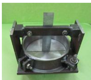
شکل (۳) - قالب فلزی و نحوه‌ی ایجاد ترک در نمونه‌ها
