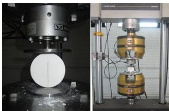
شکل (۴) - نحوه‌ی بارگذاری نمونه‌ها با استفاده از دستگاه INSTRON و سلول بار ۲۵ کیلونیوتنی
