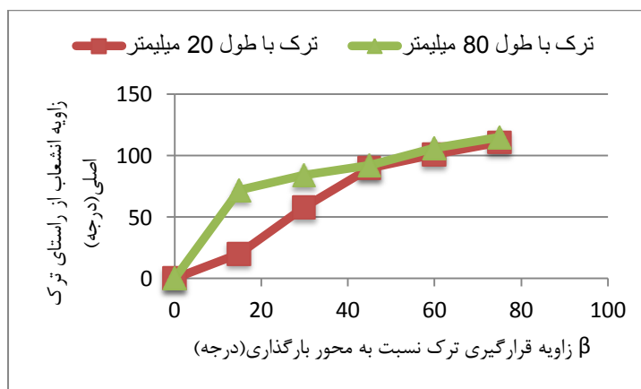
شکل (۸) - زاویه انشعاب ترک‌های کششی نسبت به راستای ترک اصلی
