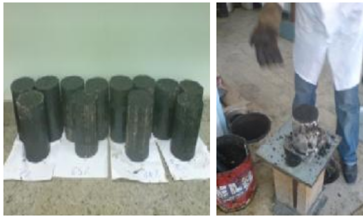
شکل ۸- چگونگی ساخت و آماده سازی نمونه ها جهت انجام آزمایش سه محوری
