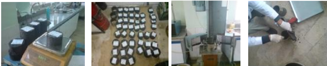
شکل ۶- چگونگی ساخت و آماده سازی نمونه ها جهت انجام آزمایش مارشال
