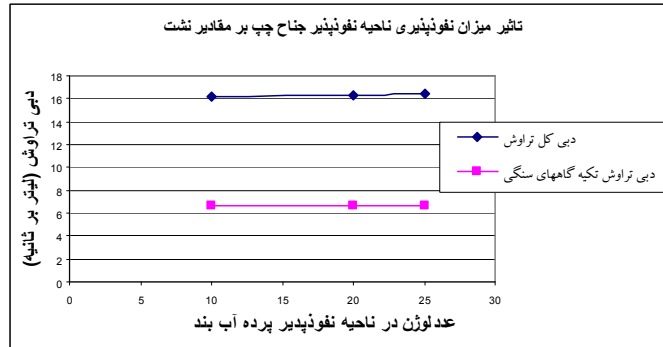
شکل (10): میزان نشت از بدنه و پی به عنوان تابعی از عدد لوژن ناحیه نفوذپذیر پرده تریق
