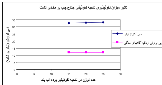
شکل (12): میزان نشت از بدنه و پی به عنوان تابعی از عدد لوژن ناحیه نفوذپذیر پرده تریق (لوژن سنگ تحتانی 3)
