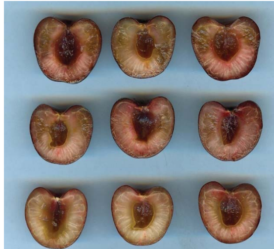
شکل ۳- لهدیگی داخلی گیلاس در اثر بارگذاری فشاری استاتیکی به ترتیب از بالا ۱۰، ۸، و ۶ نیوتن
