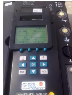
شکل (۲) دستگاه آنالیزور گاز
