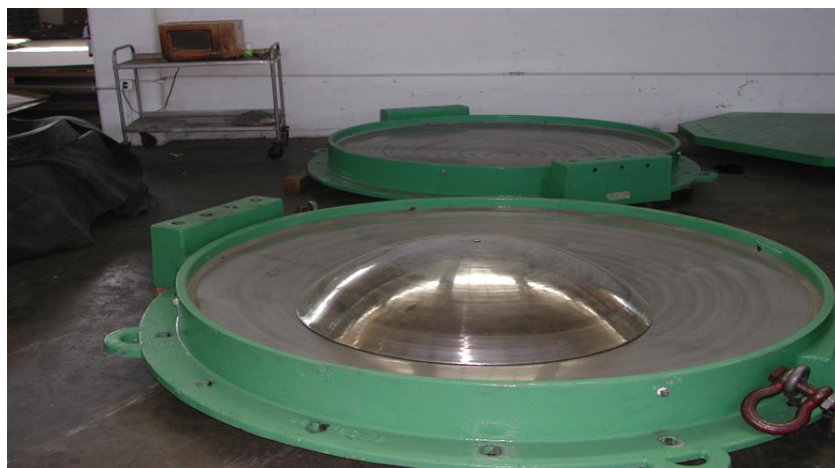
شکل (۲) جداساز اصطکاکی پاندولی
