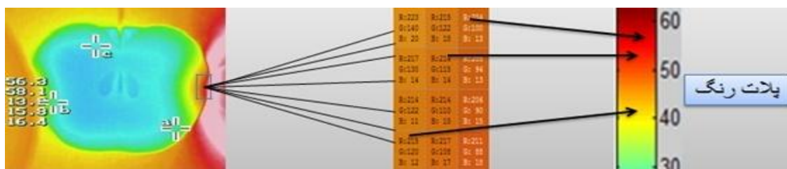
شکل ۲. نحوه ایجاد تصویر در دوربین گرمایی
