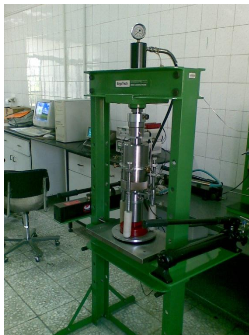
شکل ۳. دستگاه آزمایش تراسونیک تحت فشار
